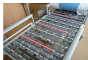
ベッドの横梁に取り付けたセンサー (ピンクの棒がセンサー)
